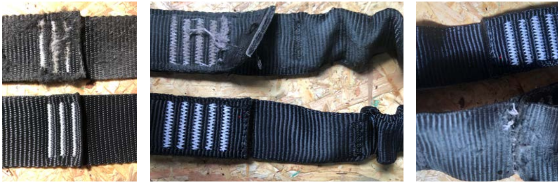
■ Figura 19 - Exemplo de cinturão com rompimento de linhas ou descosturas
